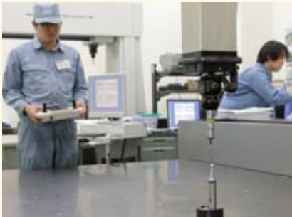
ミットヨCNC三次元測定機 FALCIO-Apex 162012
